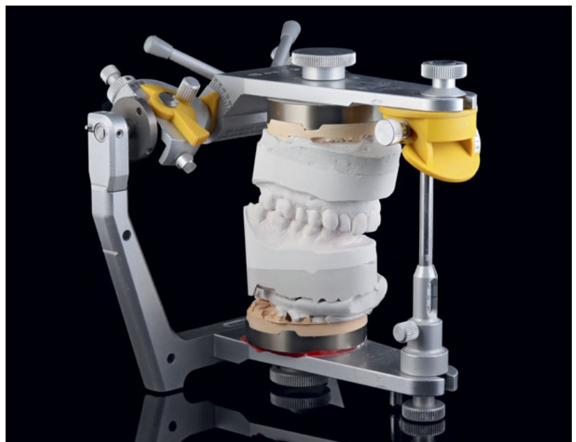
Abb. 1 Artikulierte Modelle im volljustierbarem SAM 3 (Sam Präzisionstechnik, Gauting), ein Artikulator mit justierbarem Frontzahnführungsteller.
