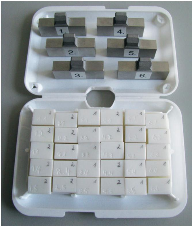
Abb. 1 Edelstahl-Vorlagen für den Scan- und Fräsprozess der Gegenstücke aus Y-TZP.
