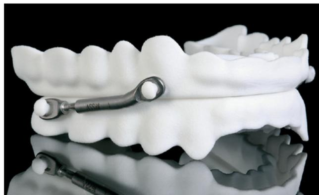
**Abb.16:** Die im SLS-Druckverfahren hergestellte, fertige Schiene.
